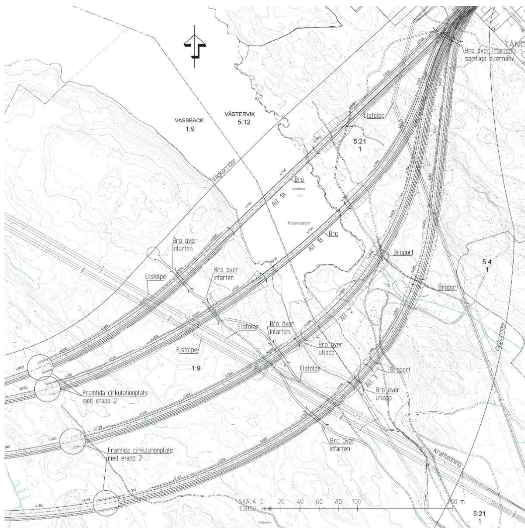
Figur 4-3: Alternativa väglinjedragningar med vägbank- samt vägsärningsavsnitt för de alternativa väglinjedragningarna vid passage av Kvännaren.
