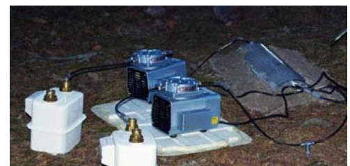
Bild 8.3: Provtagningsutrustning för provtagning av avgång från mark till luft av kvicksilver.
