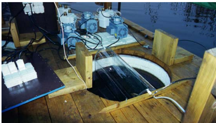
Bild 8.6: Utrustning för provtagning av luftavgång av kvicksilver från vattenytan
