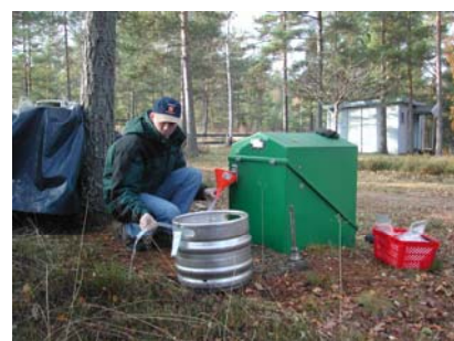
Bild 8.7: Utrustning för provtagning av grundvatten.
