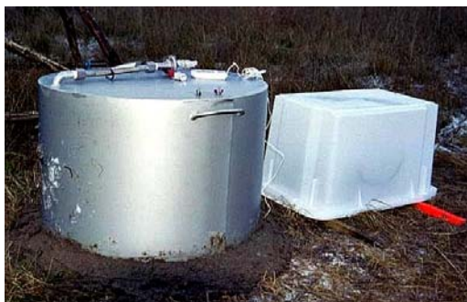
Bild 8:1 och 8:2; Provtagningsutrustning för provtagning av avgång till luft av PCB-7 och PAH-16. Bilden till vänster visar "provtagningspuffen" i vilken luftburen PCB och PAH anrikas. Puffen skickas till laboratoriet för analys.
