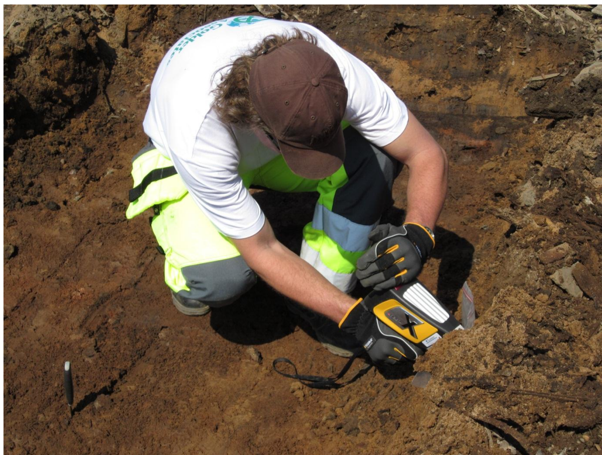
Figur 6.2. Erik Karlsson, Golder Associates AB mäter arsenikhalt i schaktvägg med XRF, innan prover sändes för laboratorieanalys. Foto: Ulrika Palmér Nilsson, EMPIRIKON Konsult AB.
