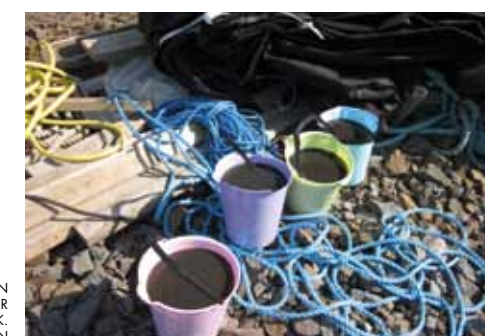
FÖRSÖK FÖR ATT SE HUR FORT BOTTENSEDIMENTEN OCH KOPPARHALTEN I VATTNET SJUNKER VID TILLSATS AV OLIKA MÄNGDER KALK. FOTO: ULRIKA PALMÉR NILSSON
