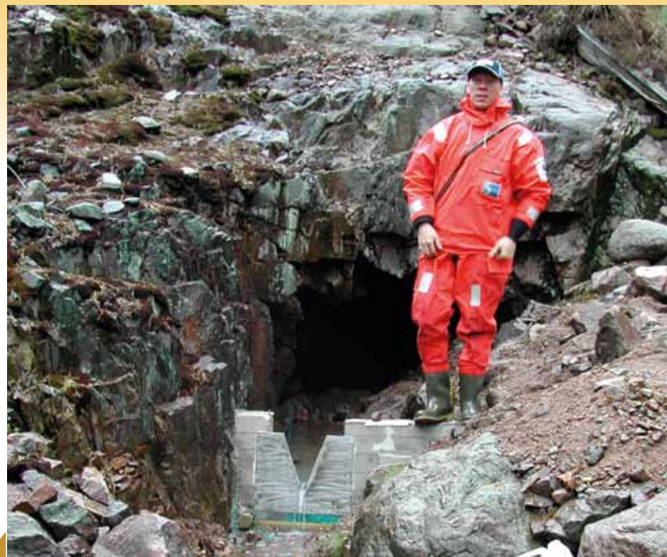
MÅTÖVERFALET UTVÄNFÖR STOLLGÅNGEN. FÖR KONTROLL AV FLÖDESHASTIGHET, VID UNDERSÖKNINGARNA INNAN SANERINGEN. FOTO: CHRISTER RAMSTRÖM, VÄSTERVIKS KOMMUN
