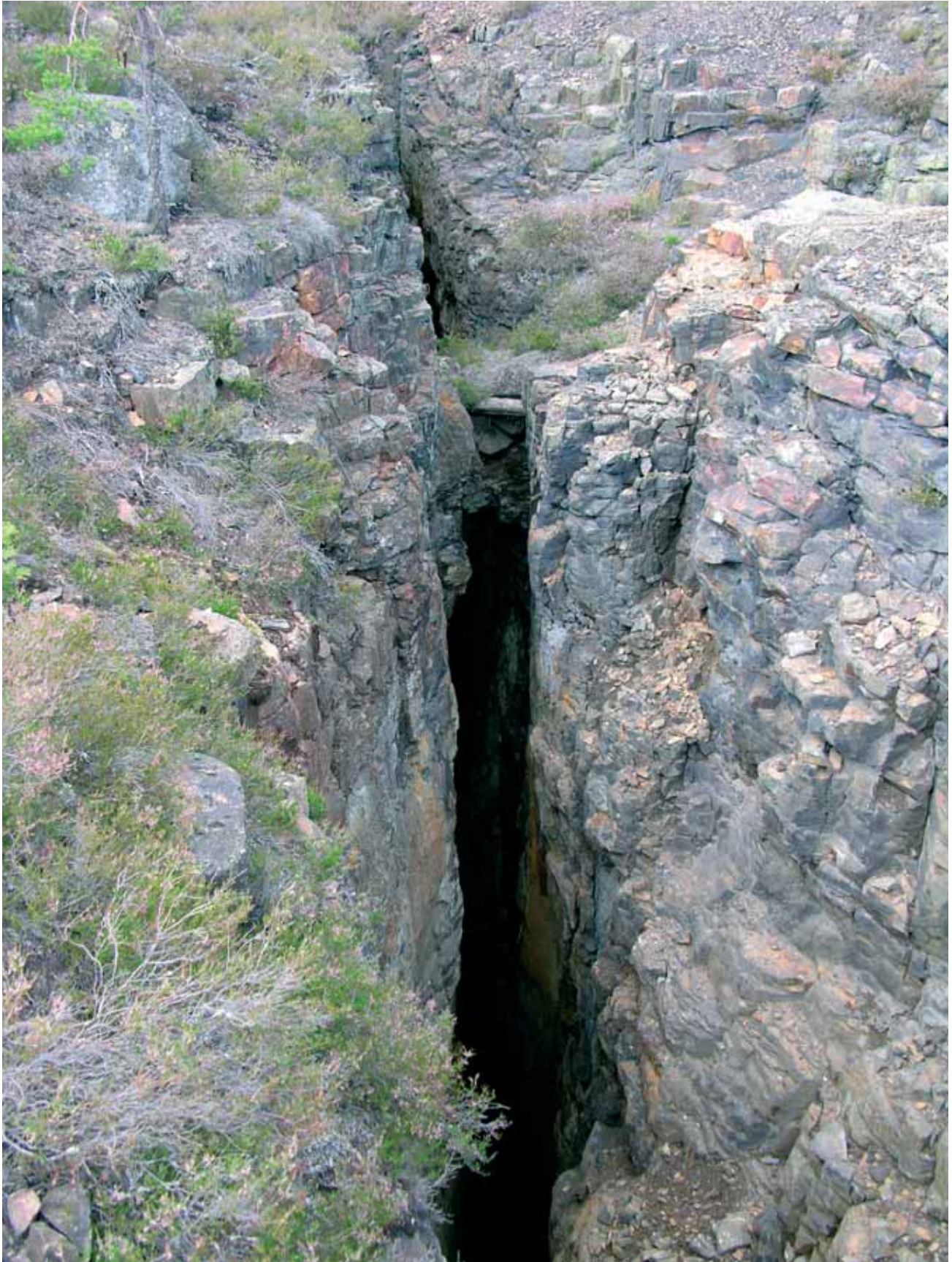
Svensk- och Odelmarksgruvan från SÖ. Tillmaktningsspår anas i schaktväggen t v i bild. Foto: F Sandberg.
