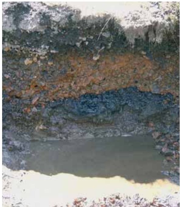
Detalj av slagvarpsdeponin i schakt 1 vid hyttan. Här syns tydligt de olika urlakningsskikten över och under grundvattnenivån. Foto:V Palm.
