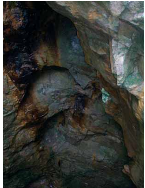
Tillmakade "grottor" som spår efter brytning i Östra Tyskgruvan Ho27. Foto:V Palm.
