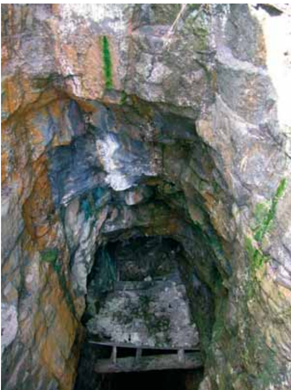
Timmerbotten i en ort i Odelmarksgruvan. I schaktväggarna syns otaliga borrsår. Foto:V Palm.
