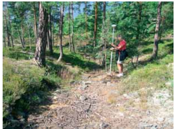
Eva Carlsson mäter in lämningar vid Tjursbosjön med DGPS. Foto: F Sandberg.
