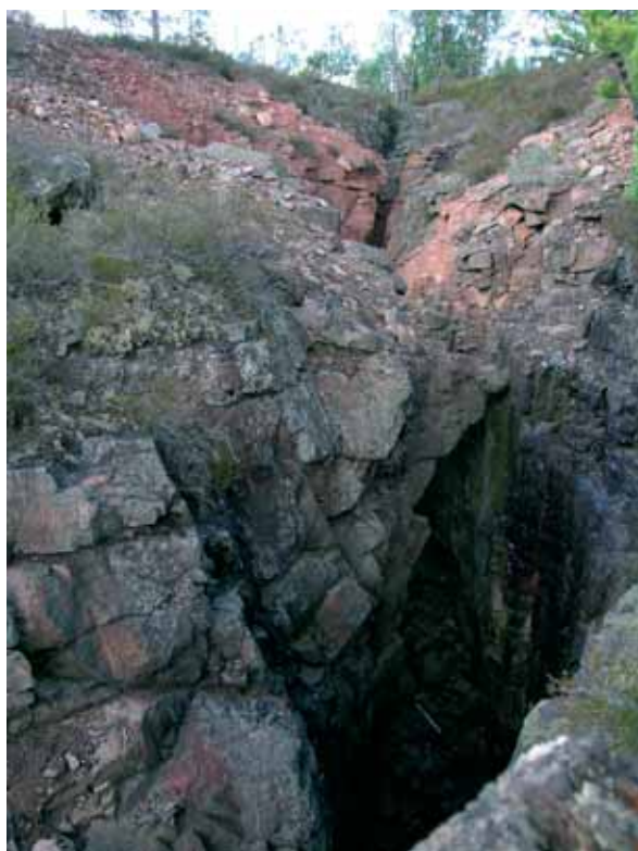
Del av Holländaregruvan Ho7 med tillmakad sida t h i bild. Foto: F Sandberg
