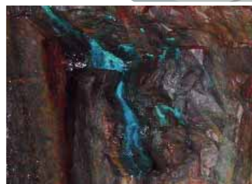
Metaller faller ut ur gruvväggarna på grund av att syret i luften får berget att vittra.
