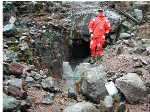
Vid mynningen av stollängan har det vatten som kommer från gruvorna kontinuerligt mätts och analyserats på metaller, här av Christer Hermansson.
