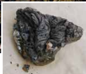
Slagghögar från smältugnarna ligger ännu kvar i gruvområdet. Slaggen är en restprodukt som till största delen innehåller järn.
