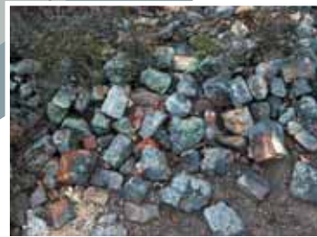
Skärsten bildas efter den första smältningen av malmen och kan innehålla upp till 15 procent koppar.
