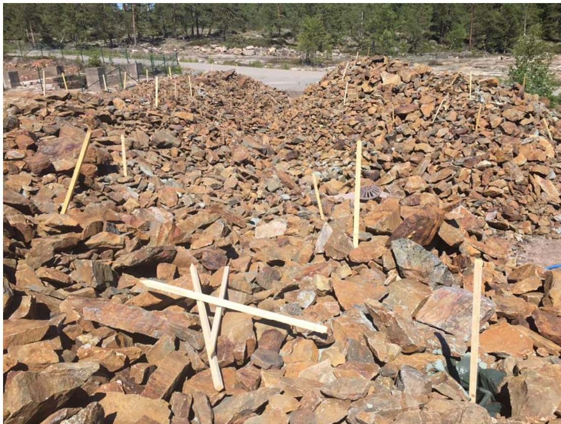
Figur 1: Illustration över injekteringstäthet över de olika högarna. Notera brunnen i mitten av bilden som är en av brunnarna bland högarna som leder allt lakvatten till en gemensam utloppsbrunn.
