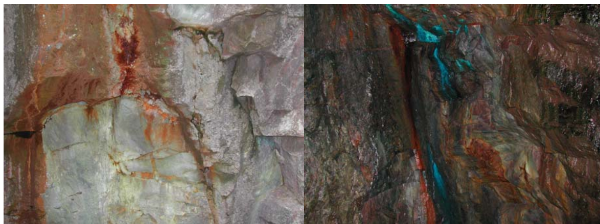
Bild 1. Fotografierna visar olika typer av utfällningar på brottväggar i gruvan. Till höger visas sannolika kopparkarbonatutfällningar (azurit) samt järnoxidhydroxidutfällningar. Till vänster visas utfällningar av järnoxidhydroxid och gips.
