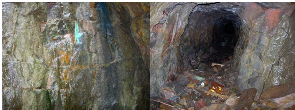
Bild 2. Fotografierna visar olika typer av utfällningar på brottväggar i gruvan. Till höger visas sannolika kopparkarbonatutfällningar (malakit) samt järnoxidhydroxidutfällningar. Längre in i gången är golvet täckt av gröna utfällningar. Till vänster visas utfällningar av järnoxidhydroxid och malakit
