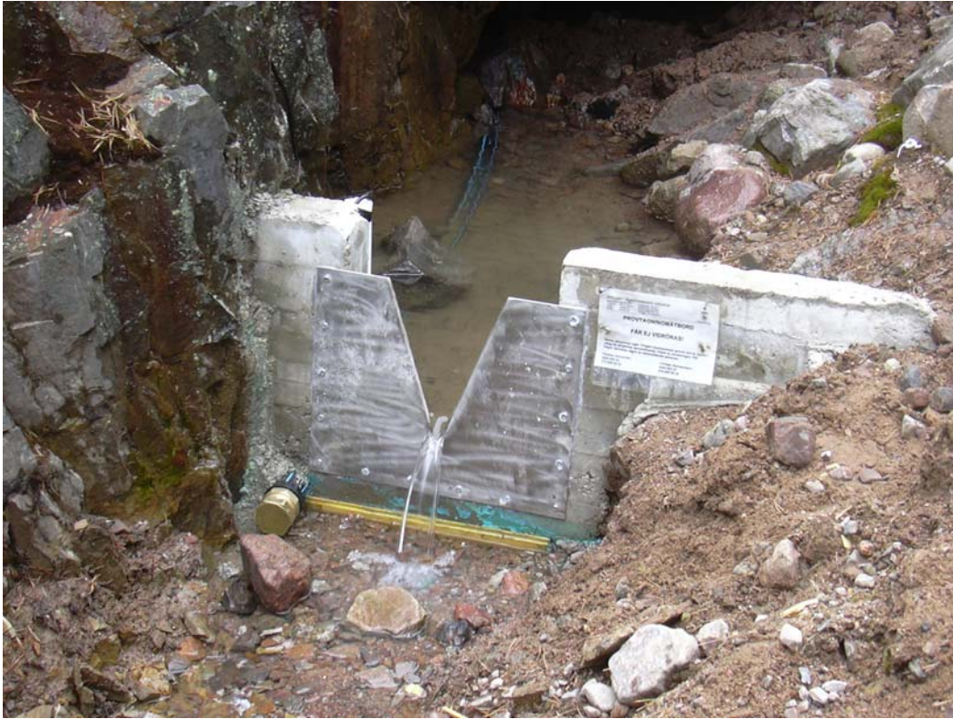
Figur 15 V-format mätöverfall för flöde, installerat i stollgångens utlopp.
