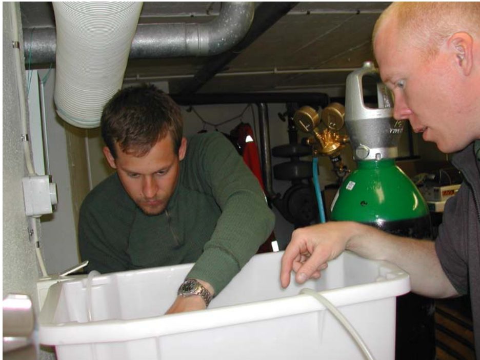
Bild 5. Porvattenpressning i box. Argongas är tyngre än luft och en helt syrefrimiljö erhålls i plastboxen. Henning Holmström, Envipro Miljöteknik AB och Christer Hermansson, Västerviks kommun i aktion. Foto: Christer Ramström
