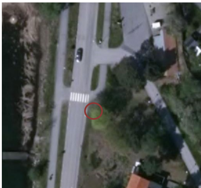
Figur 7. Korsning med Slottholmsvägen. Röd markering visat var siktförbättringar kan ske. (Eniro Kartor)
