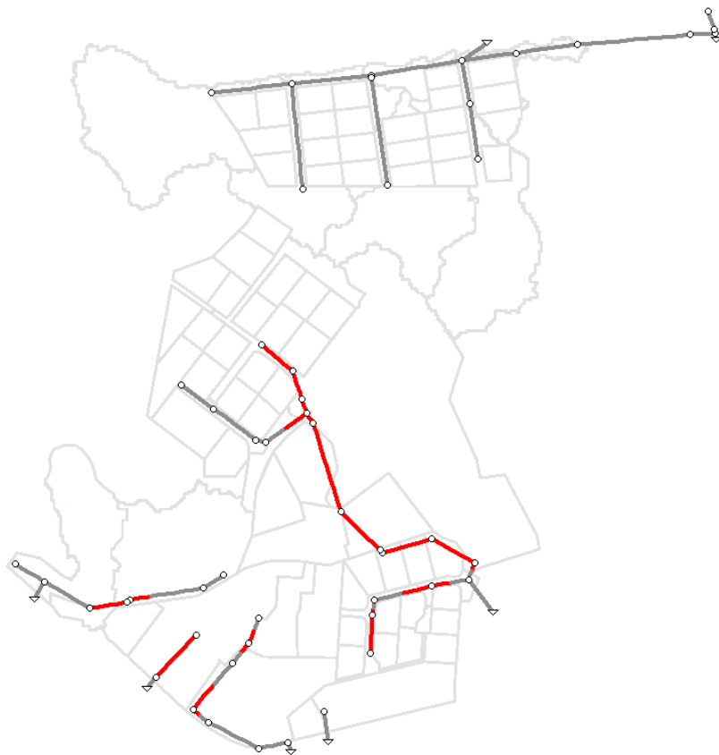
Figur 10 Översiktskarta, nuläge för dagvattensledningsnätet med 10-årsregn utan klimatfaktor. RÖD = marköversvämning. GRÅ = ej marköversvämning
