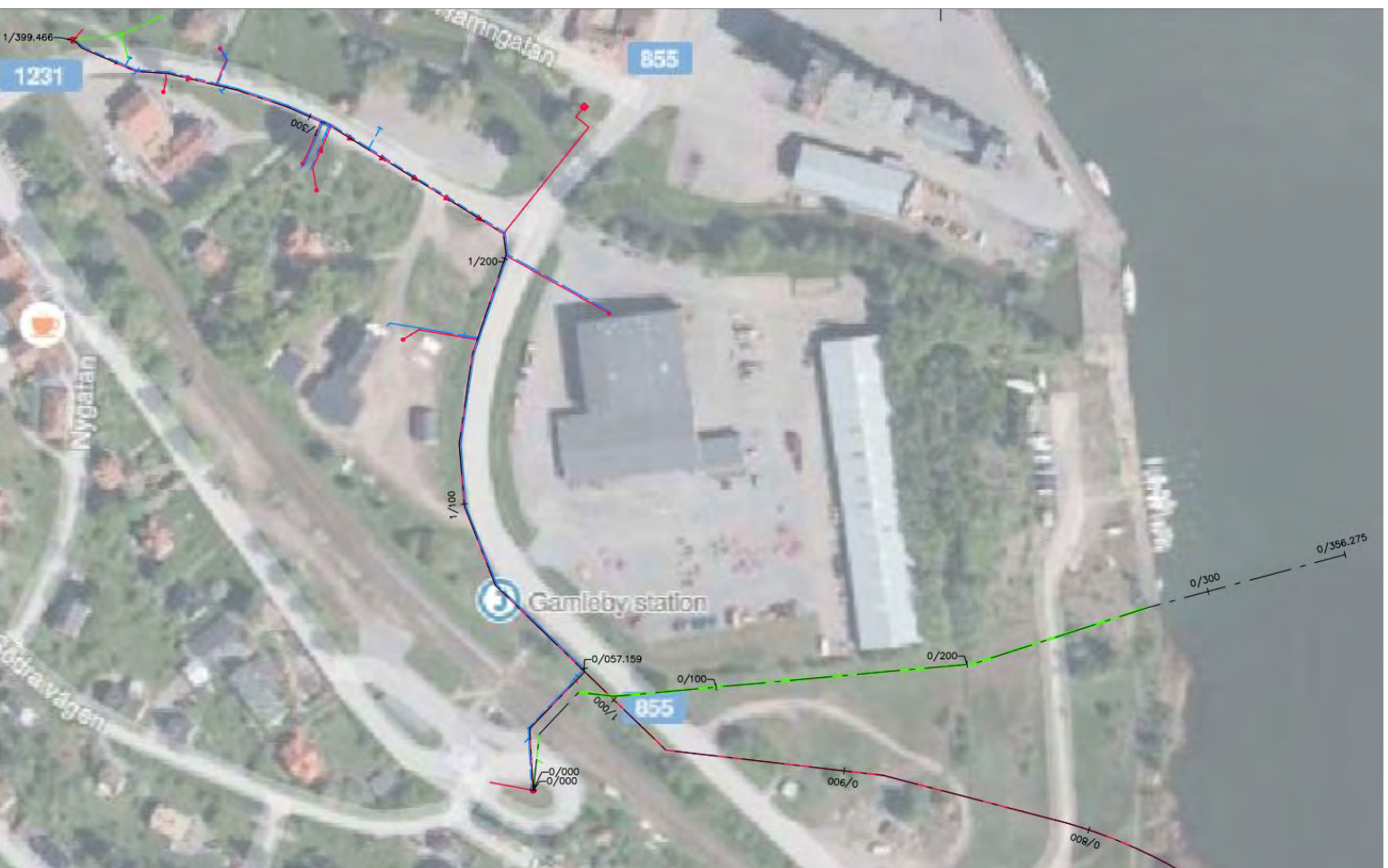
Figur 9. Röd ledning, spillvattenledning (tryckavlopp) 0/800-1/400 samt grön ledning dagvattenledning PST2 Brådd 0/000-0/356. Källa kartunderlag: www.hitta.se samt Figur 1 enligt Tyréns utredning.
