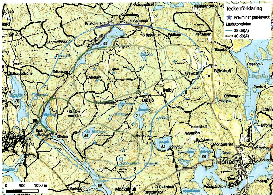
Kartan illustrerar ljudutbredning från vindkraftsparken baserat på verken Vestas V126-3.45MW med torn höjd på 137m.
